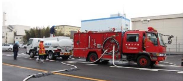
タンクローリーによる消防車への給油の様子
