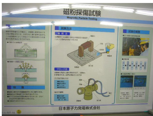
非破壊検査による磁粉探傷試験
