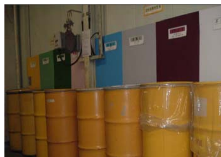
15種類の分別管理がされている固体廃棄物置き場
